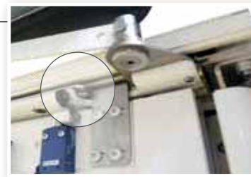
Vérouillage mécanique du portillon dès que la porte de garage s'ouvre
